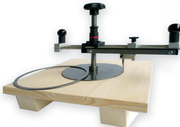
Устройство с ручным приводом для вырезки кругов и колец.
