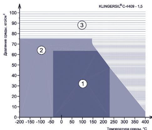
Диаграммы давление-температура действительны для прокладок толщиной 1,5 мм, шириной не менее 20 мм. Если параметры рабочей среды находятся в зоне 1, предварительное проведение испытаний не требуется, в зоне 2 проведение испытаний рекомендуется, в зоне 3 проведение испытаний обязательно
