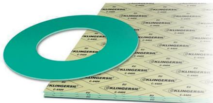
**KLINGERSIL® C-4409** - уплотнительный материал на основе синтетических волокон, связующее - NBR (бутадиен-нитрильный каучук), имеет армирование просечно-вытяжной конструкционной сталью 1.1203.
