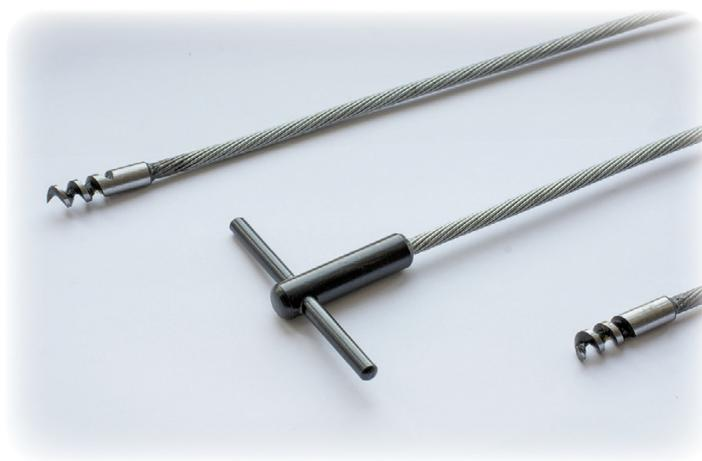
Экстрактор представляет собой гибкий тросик из стального каната, на одном конце которого закреплен винтовой наконечник (аналогичный штопору) из закаленной стали, остро заточенный, на другом конце – Т-образная ручка.
