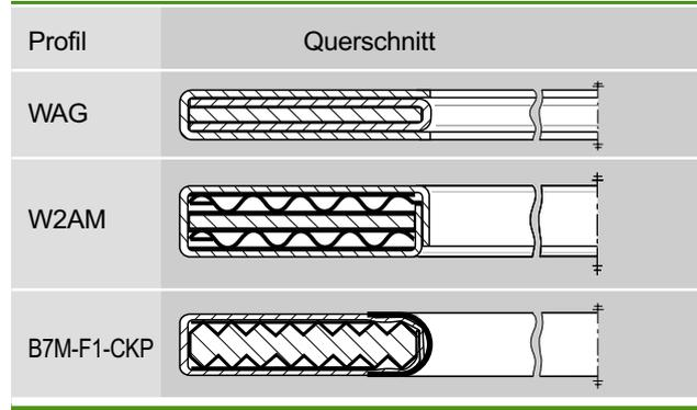
Bei Dichtungen nach **Profil W2AM** wird der innere Stahlring mit gewellten Dichtungen mit Graphitauflage belegt und abschließend mit Glasgewebe ummantelt. Die Dichtungen werden in der Regel mit einer Imprägnierung versehen.
