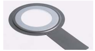
Многоразовая фланцевая прокладка из листового ТРГ, армированного гладким нержавеющей стальным листом, плакированная ПТФЭ, с нержавеющей стальным установочным кольцом и державкой для установки и извлечения.
